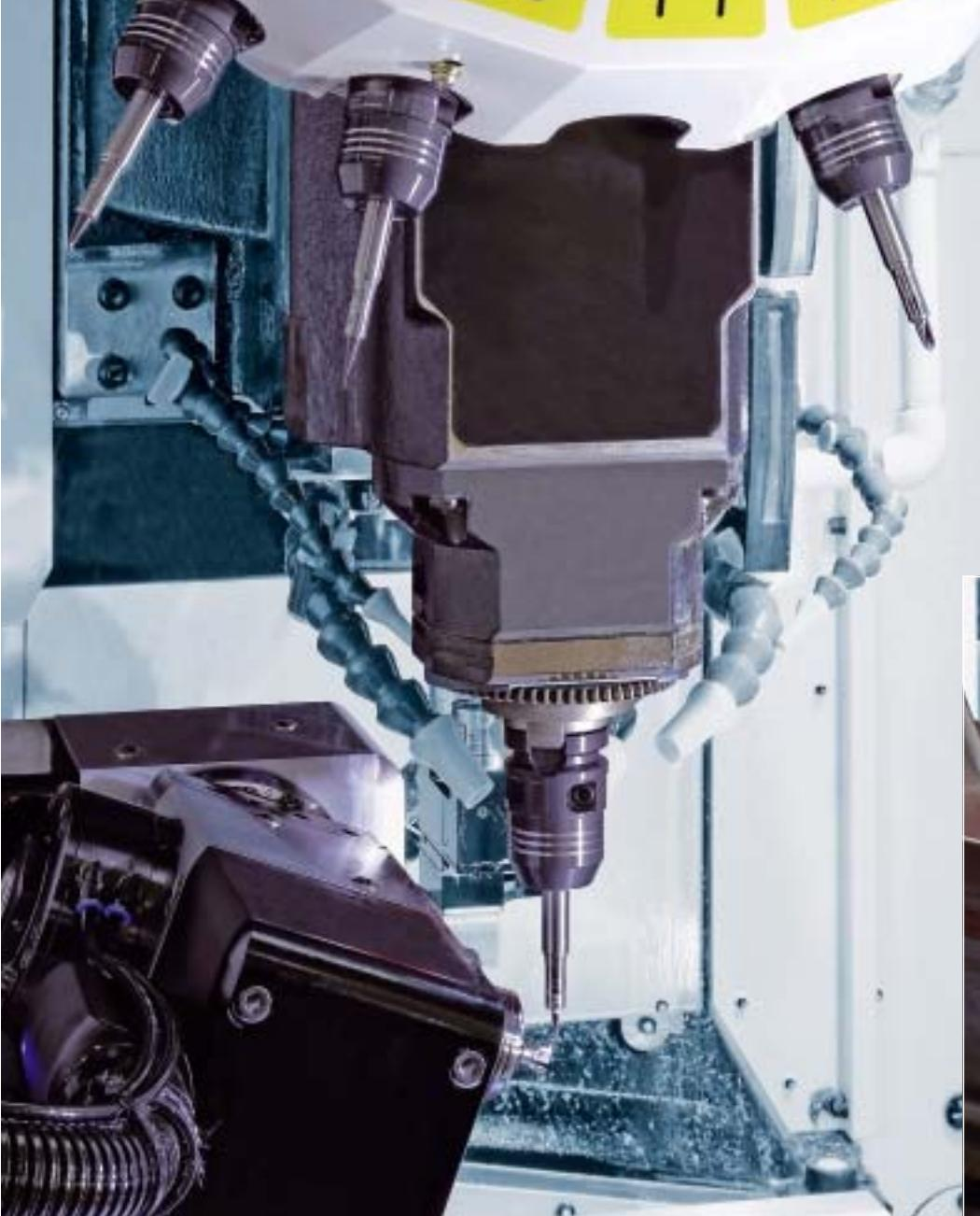
Um die Möglichkeiten der 5-Achs-Maschine voll auszuschöpfen, nutzt Strub die schlanken Schunk-Werkzeugverlängerungen Tribos SVL
